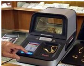
Figure4: DXL Metal Analyzer
